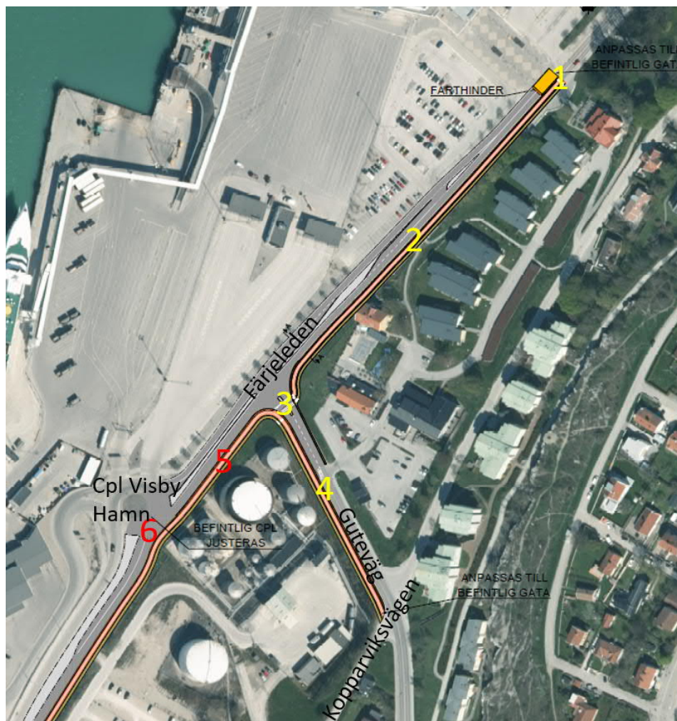
Figur 47. Första sträckan av Hamnåtgärden. Kryssningsresenärer vägleds från Färjeleden söderut/österut längs Gutevägen innan de svänger in västerut/söderut på Kopparviksgatan och vidare mot gångbron.
