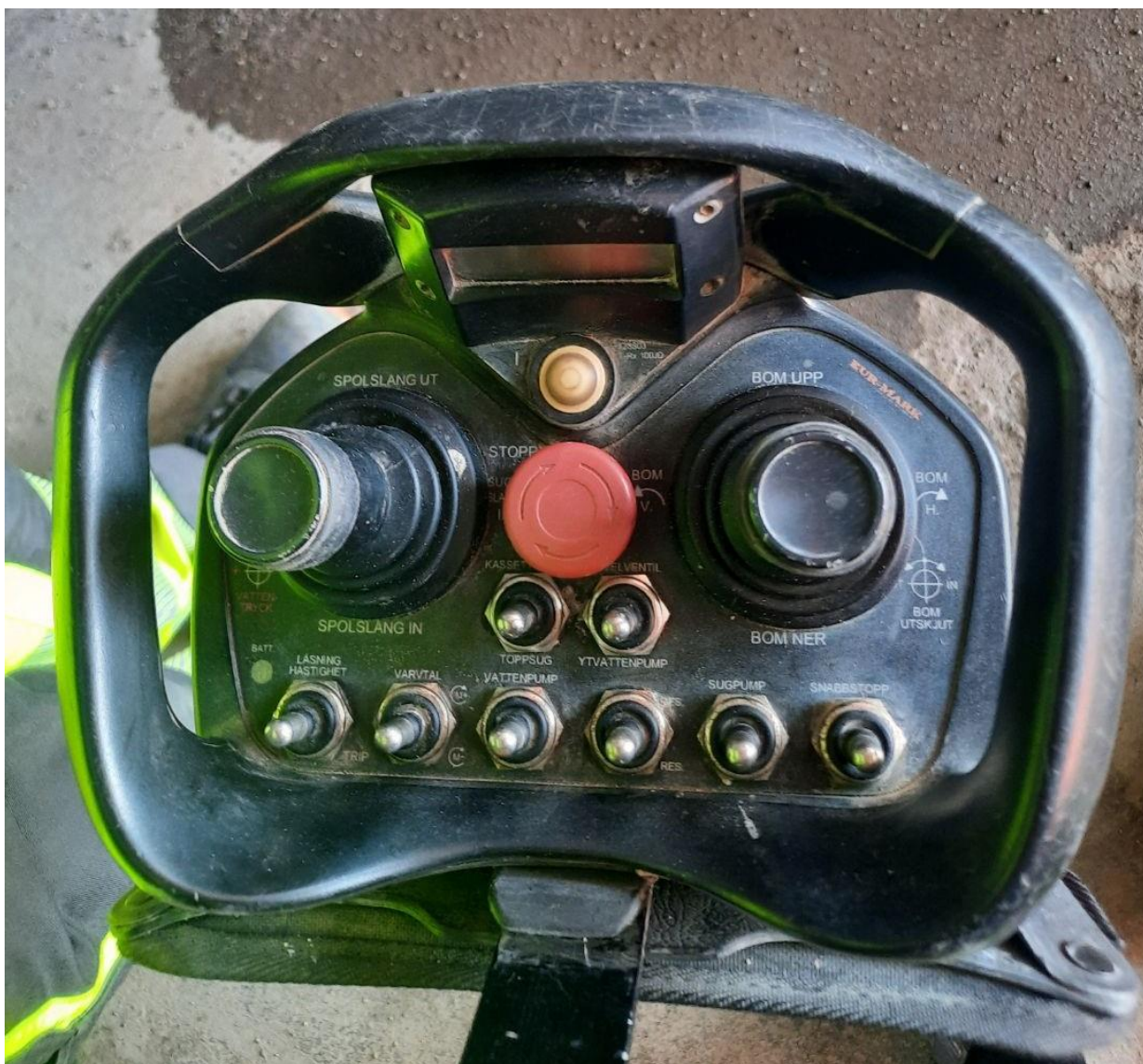
En av två fjärrkontroller till spolbilen YAC 353. Vattentrycket regleras steglöst med hjälp av ratten på den stora spaken till vänster.
