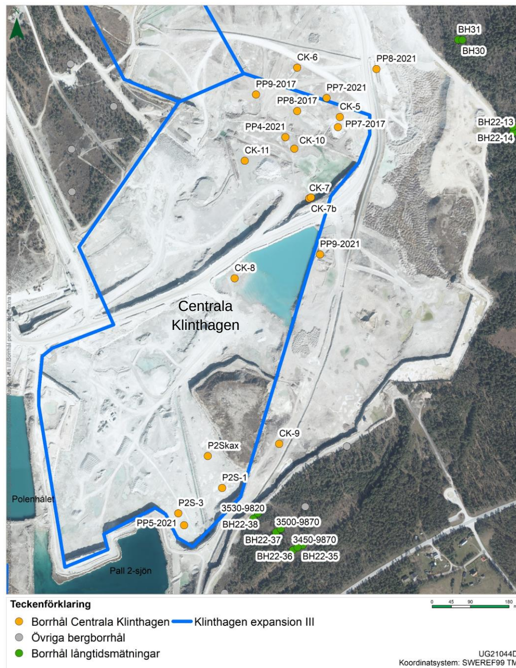
Figur 29. Borrhål som har använts för undersökningarna för Centrala Klinthagen.
