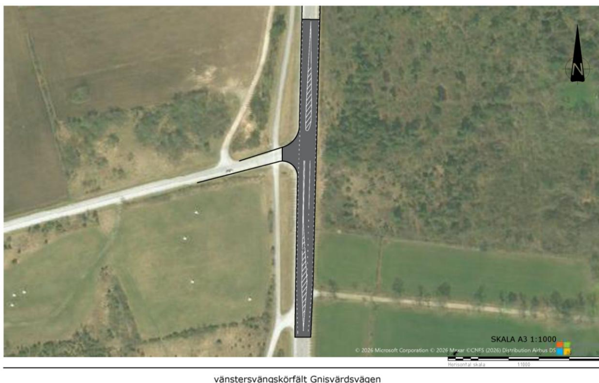
Figur 21. Illustration över föreslaget vänstersvängskörfält i korsningen Gnisvårdsvägen södra
