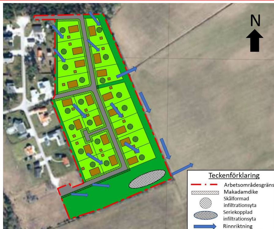
Figur 19. Skiss över föreslagna dagvattenhantering för planområdet. Källa: Dagvattenutredning Rejlers 2024-11-18.
