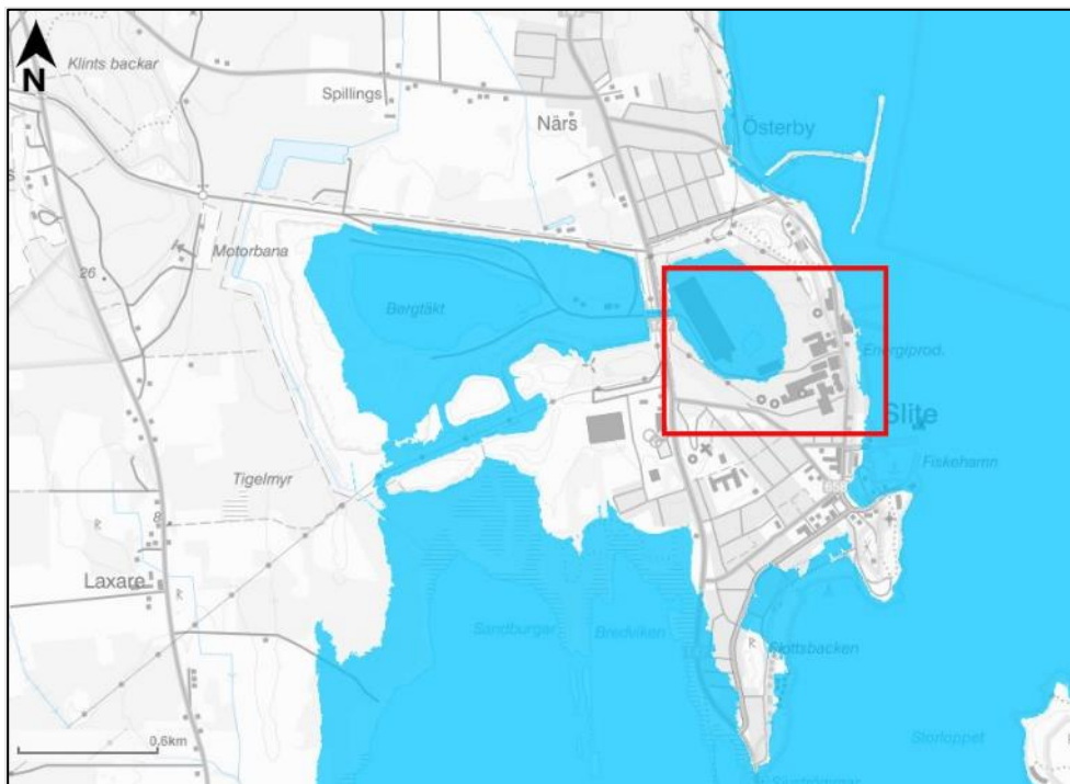
Figur 17. Översvämmad mark vid havsnivåhöjning på 2,5 m vid anläggningen i Slite, cementfabriken anläggningsområde är inringat i rött.
