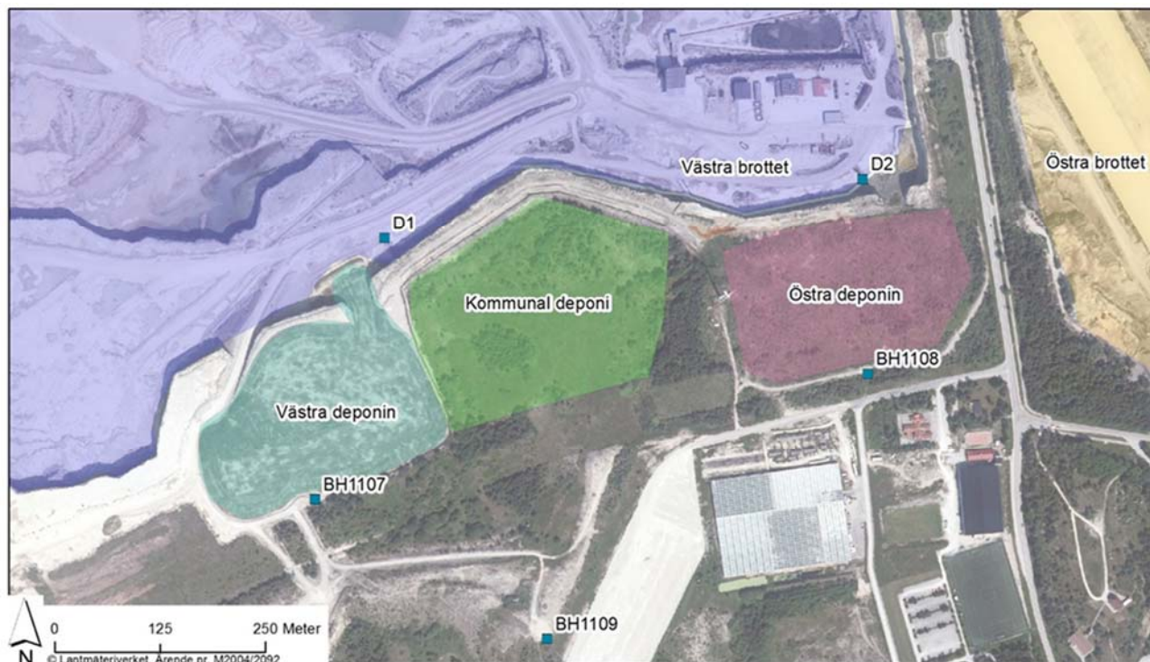
Figur 4: Lokalisering av kontrollbrunnar och mätpunkter för kontroll av lakvatten.
