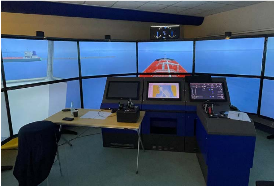
Figur 3.1 Simulering med azipod framdrivning i RISE fartygssimulator.
