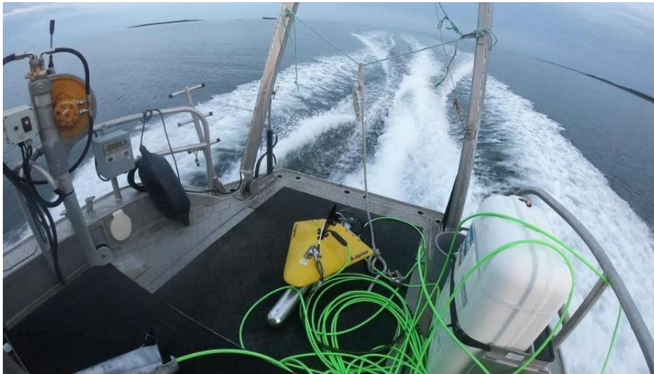
Figur 5 Sideseende sonar med monterad depressor under transit ut till mätområdet
