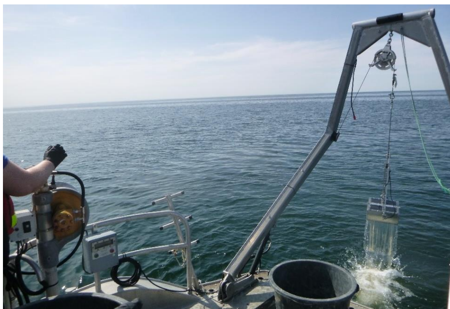
Figur 7. En van Veenhuggare sköljs ren efter avslutad provtagning. Bild från M/V Bruce akterdäck maj 2023.
