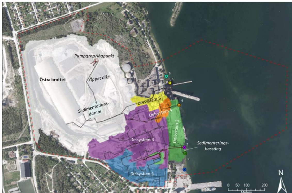
Figur 3-5. Områden som omfattas av dagvattenutsläpp till recipient från nuvarande verksamhet. Varje delsystem har varsin utloppspunkt i recipienten. Sedimenteringsdammen i Östra brottet avvattnas i första hand till utlopp 3 och i undantagsfall till utlopp 5. Utloppspunkt 6 används endast som utlopp för kylvatten. Från bilaga A3.
