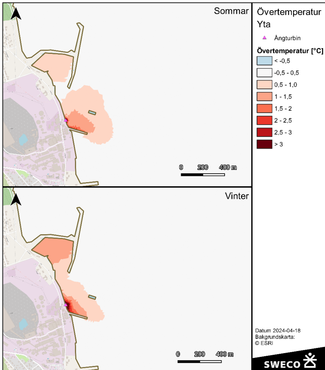
Figur 5-1. Övertemperatur vid ytan för scenariot med kylvattenutsläpp från ångturbinen. Från bilaga B.
