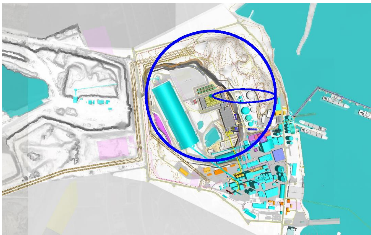
Figur 27. Molnets genomskäring på 35 meters höjd. Blå cirkel visar skadeavståndet till AEGL-2 (långvariga, irreversibla, allvarliga hälsoeffekter) efter 30 minuters exponering. AEGL-3 uppnås inte på denna höjd.
