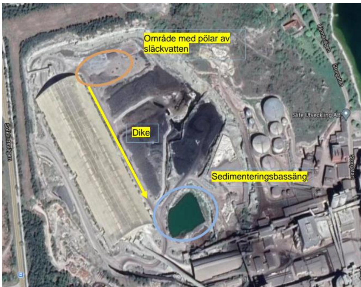
Figur 18. Brandplats i Östra brottet markerad med orange elips. Gul pil markerar det förorenade släckvattnets avrinning mot sedimenteringsbassäng. Figur från händelserapport.
