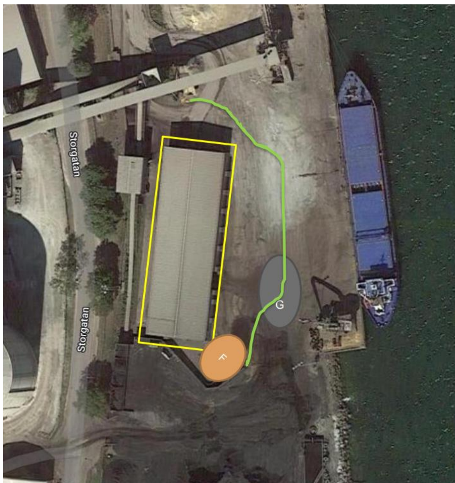
Figur 19. Branddrabbade hallen inringad i gult. F anger placering av branddrabbad FAB utanför hallen. Markerat i grönt är ungefärlig invallning. Figur från händelserapport.
