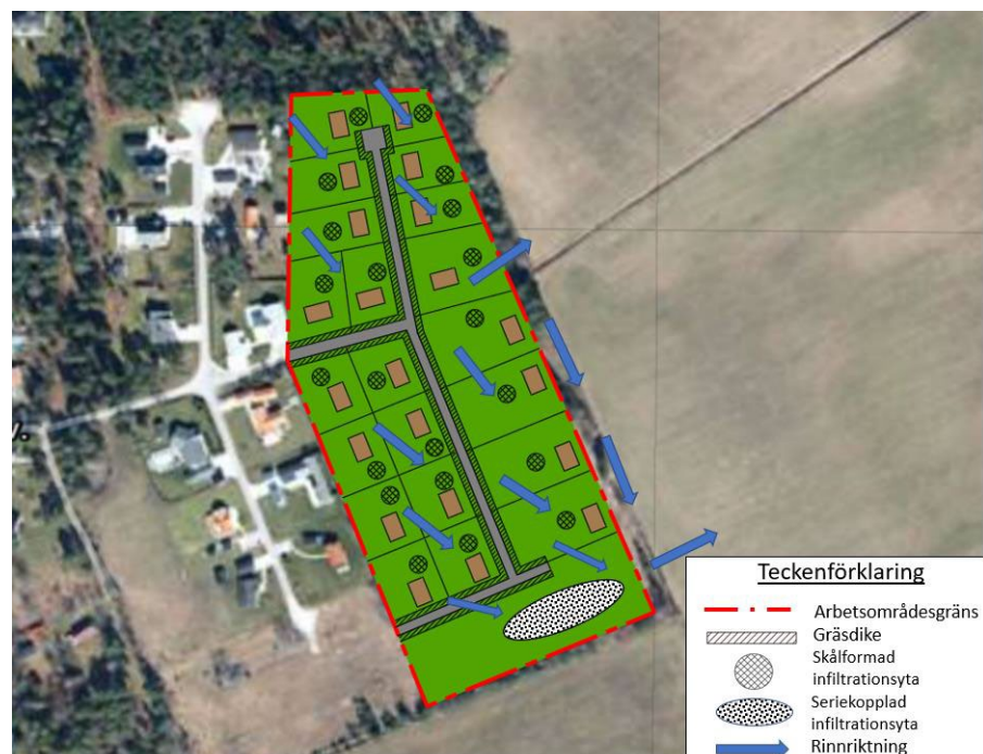
Figur. Skiss över föreslagen dagvattenhantering för planområdet. Källa: Dagvattenutredning Rejlers 2023-03-09.
