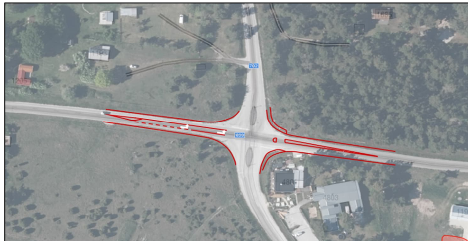
Figur 20. Typlösning vänstersväng väster om Ekekorset och gc-passage över ett körfält i taget.
