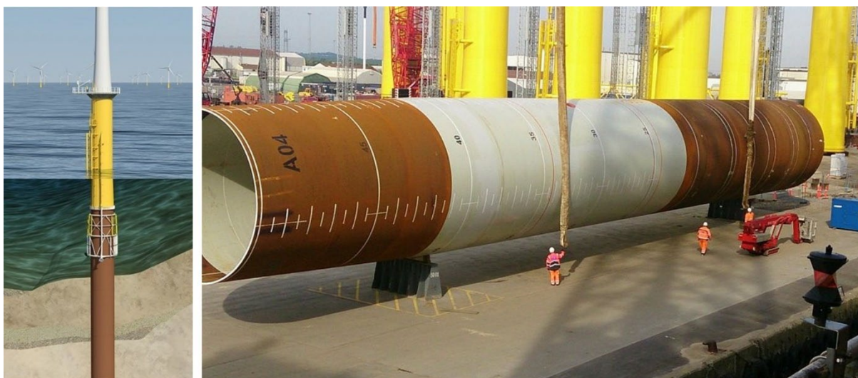
Figur 9. Till vänster: Illustration av monopilefundament. Till höger: tillverkning av monopilefundament. I bakgrunden syns färdiga övergångsstycken. Källa: COWI.
