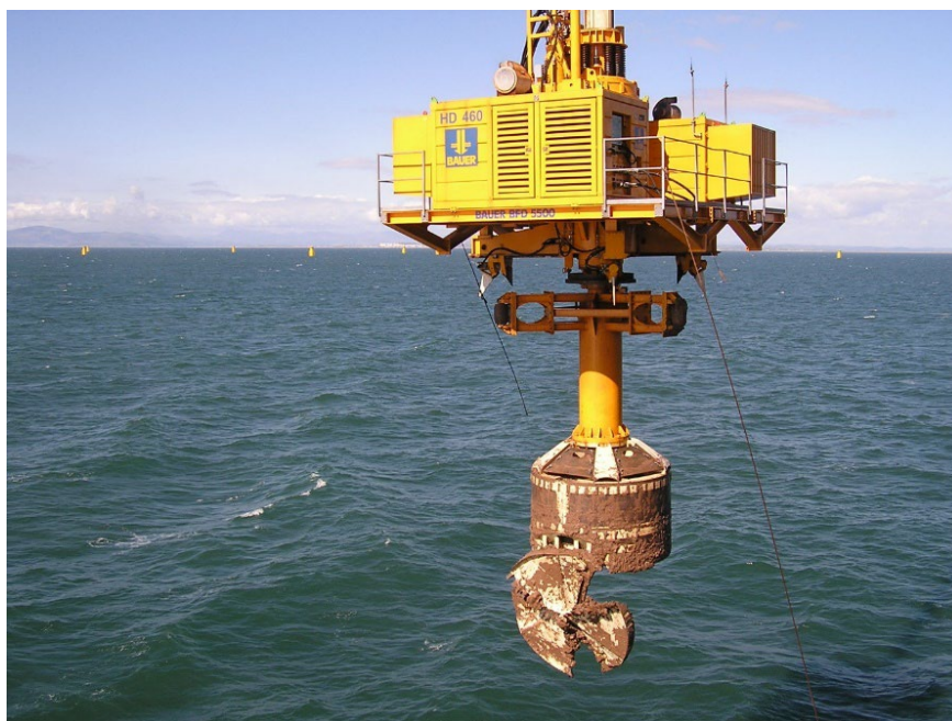
Figur 21. Exempel på borrar som kan användas vid borrarning av pålar. Källa: Bauer Group.
