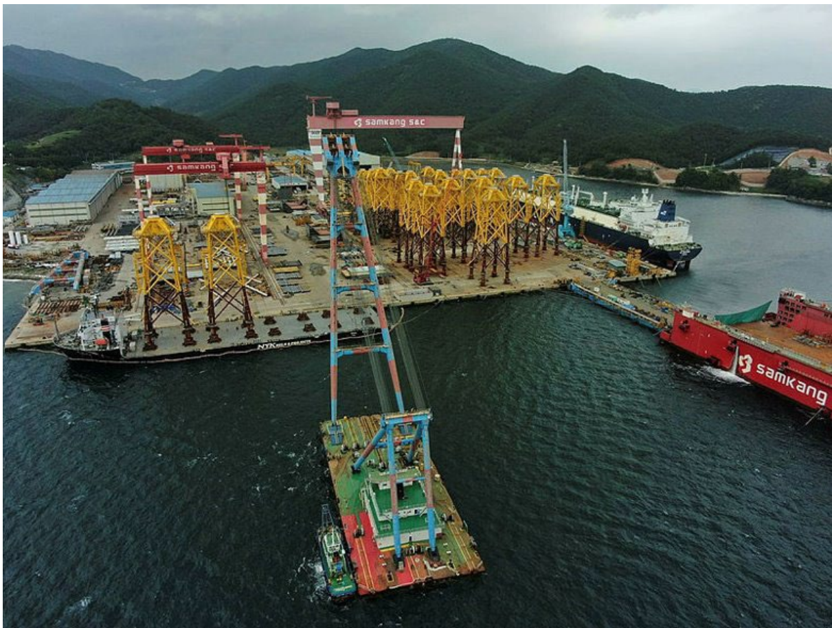
Figur 11. Fackverksfundament vid kaj. Källa: COWI.
