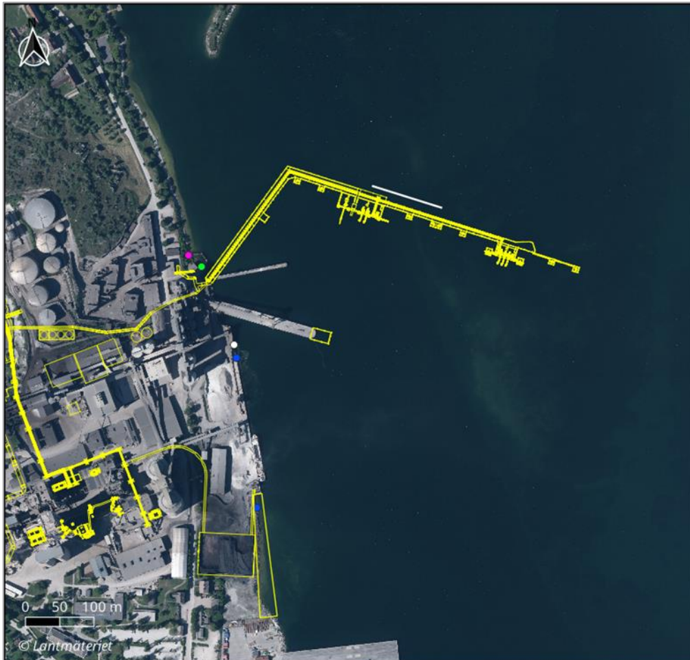
Figur 8.5 Intagspunkt för kylvatten fabrik (vit punkt), utsläppspunkter för kylvatten (blå punkter) samt ångturbinens befintliga intags- (grön punkt) och utsläppspunkt (rosa punkt).
