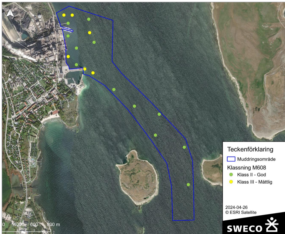
Figur 11.13 Ansökt muddringsområde med provpunkter bedömda enligt norska effektbaserade kriterier. (Källa: Bilaga B4)
