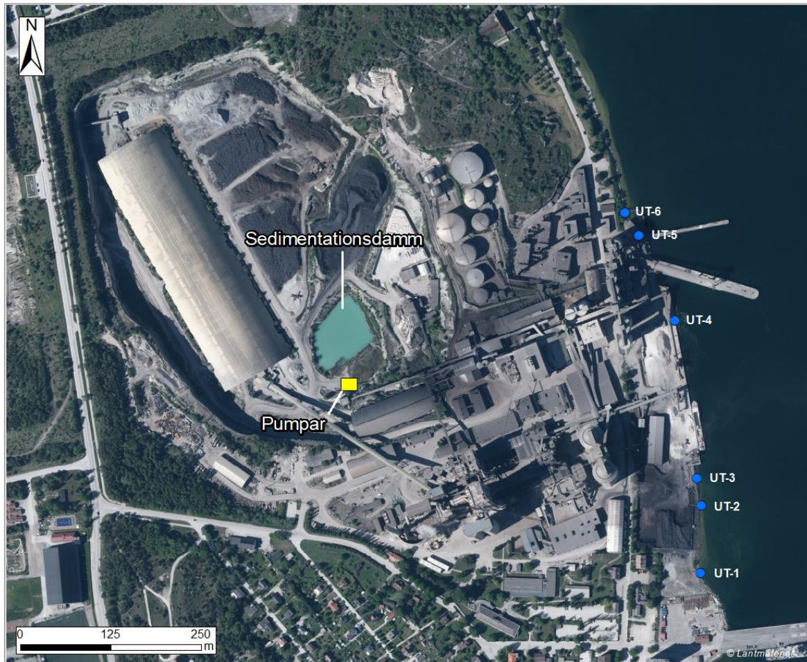
Figur 8.6 Principskiss utsläppspunkter i befintligt dagvattensystem.
