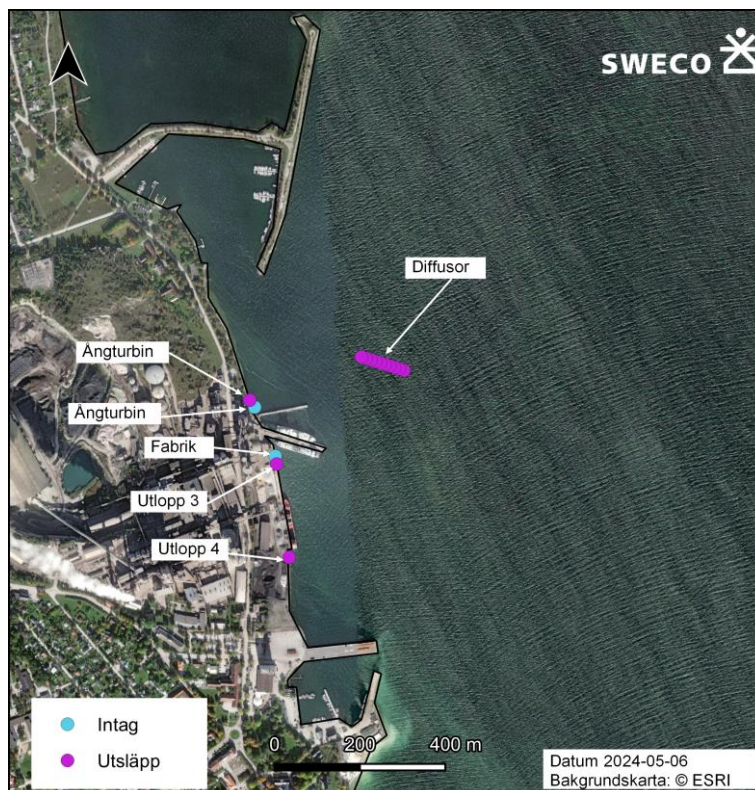
Figur 11.18 Intags- och utsläppspunkter för kylvatten. (Källa: Bilaga B4, underbilaga B)
