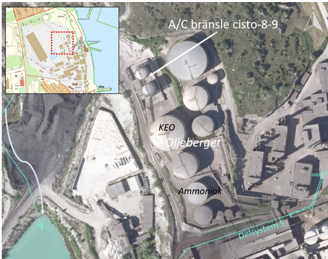
Figur 9 Avtappning till Östra brottet från Oljeberget sker endast från invallningen för A/C bränslecistern 8 och 9. Övriga dagvattenbrunnar i Oljeberget som är stängda i normalläge går via oljeavskiljare till dagvattennät inom delsystem 5.
