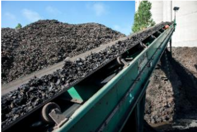
Figur 12-2 Gummi krossat till finfraktion ca 50x50 mm.
