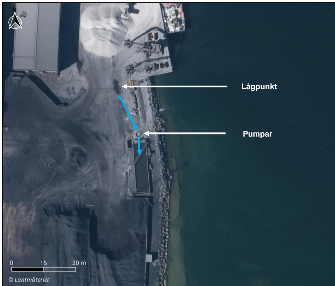
Figur 14-4 Sedimentationsbassäng i hamnen.
