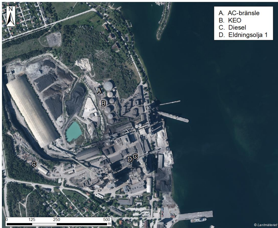
Figur 12-4 Lagring av flytande bränslen.
