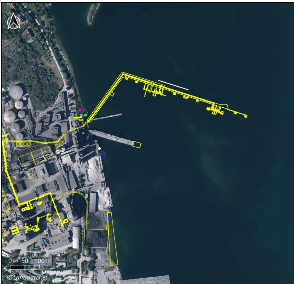
Figur 13-2 Intagspunkt för kylvatten (vit punkt), utsläppspunkter för kylvatten (blå punkter) samt ångturbinens befintliga intags- (grön punkt) och utsläppspunkt (rosa punkt).
