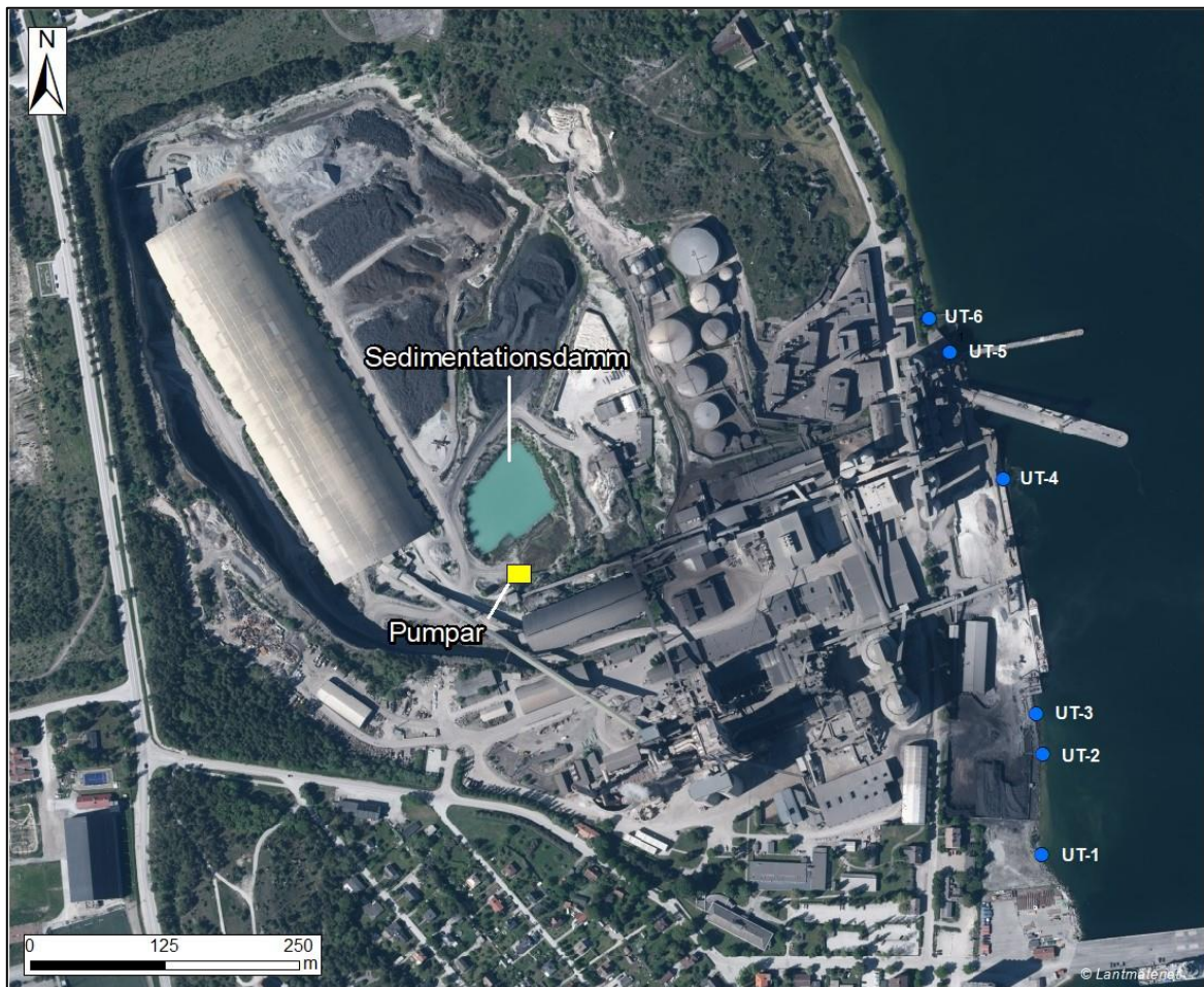
Figur 14-1 Principskiss utsläppspunkter befintligt dagvattensystem (UT = utlopp).
