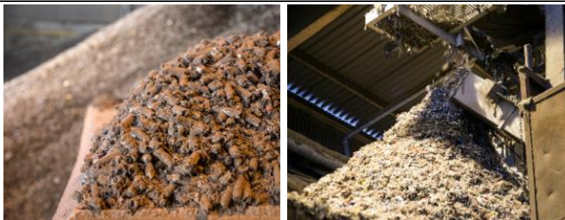
Figur 12-3 Förädlad avfallsbränsle som används i verksamheten, pellets (t.v.) och krossade FAB-balar (t.h.).
