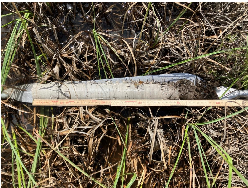
Figur 6. Jordprofil med ryssborr från södra bäckenet. Övre bilden visar den nedersta delen av jordprofilen och den nedre visar den yttigaste delen. I den senare syns ett lager av gyttja och kärrtorv med en mäktighet på ca 0,1 m. Blekeprofilen uppvisar varvighet i hela profilen. Inslag av organiskt material kan ses i den varviga profilen.
