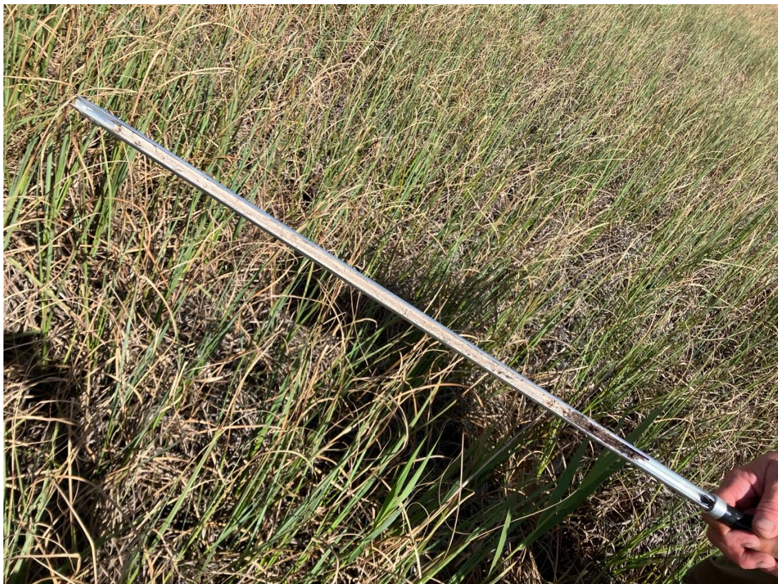
Figur 4. Typisk jordprofil i norra bäckenets djupare delar, dvs. i agmyren. Större delen utgörs av "sjöbleke" med ett litet lager av kärrtorv ovanför.
