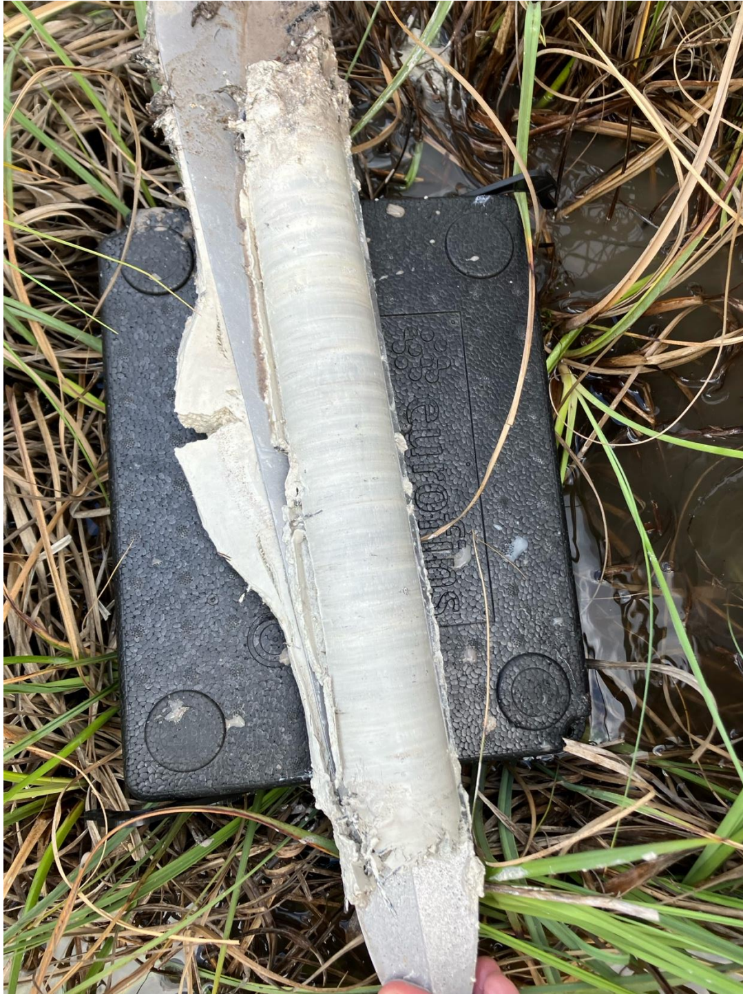
Figur 5. Jordprofil med ryssborr från norra bäckenet. Bleke dominerar hela profilen och i övre delen finns inblandning av gyttja och kärrtorv. Bleken uppvisar en tydlig varvighet och visar på successiv sedimentation mellan år och olika klimatologiska tidsperioder.
