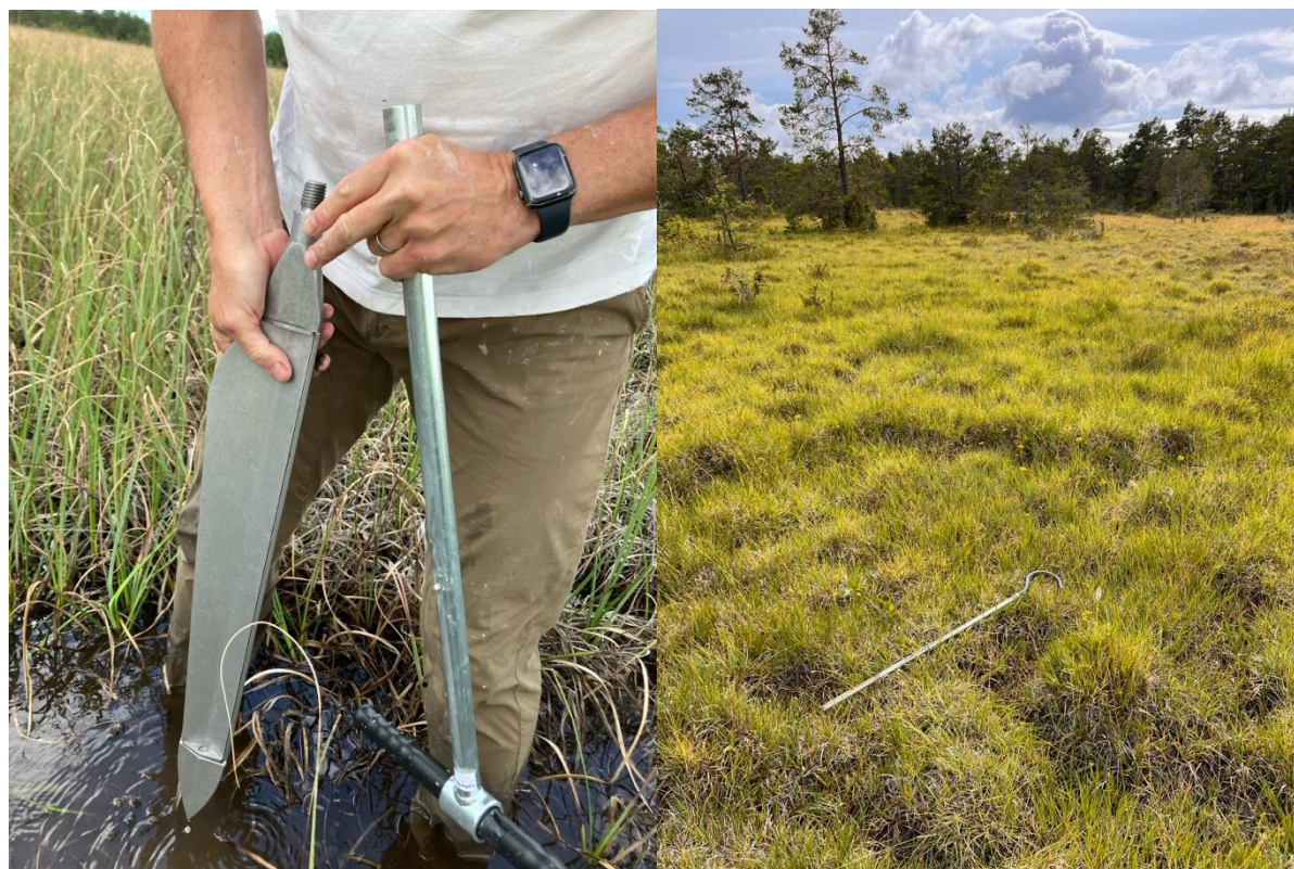
Figur 1. T.v. en ryssborr och t.h. en geosond.
