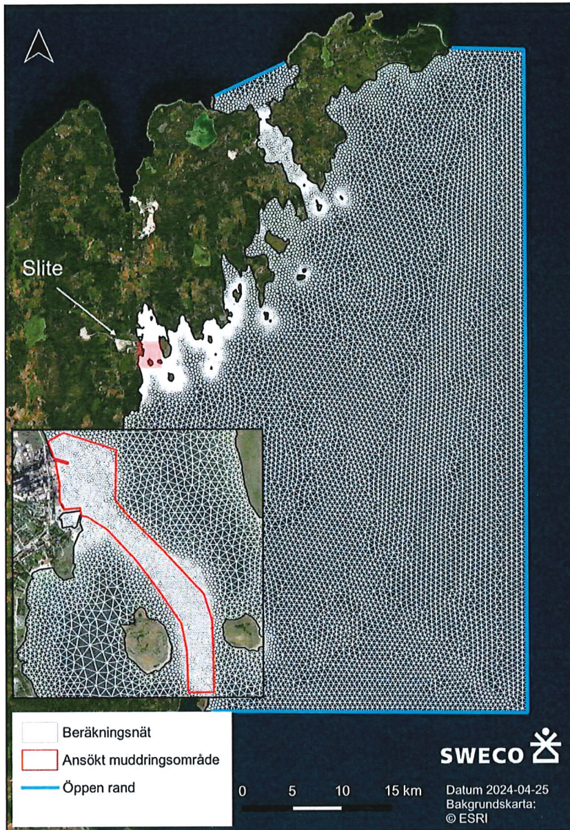
Figur 3-1 Modellområde med beräkningsnät, vattendrag och öppna ränder mot havet. Ansökt muddringsområde visas i den mindre kartan.
