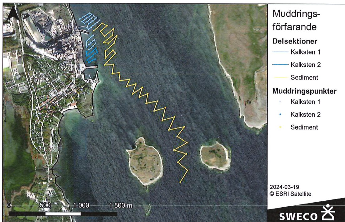
Figur 4-7 Muddringsförfarande i modellen. Inledningsvis muddras delsektionerna Kalksten 1 och Sediment . När den senare är färdig påbörjas muddring av Kalksten 2 .
