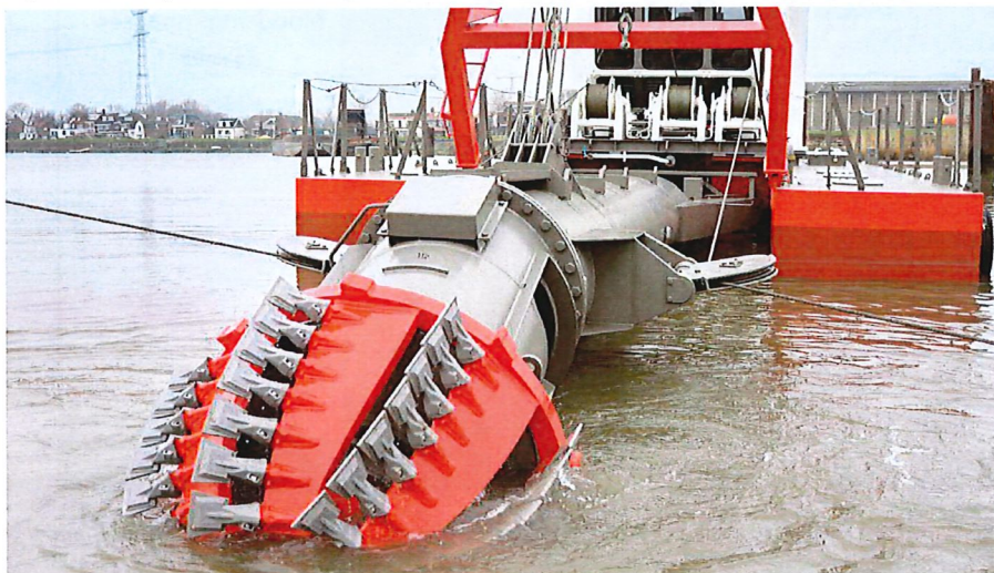
Figur 4-6 Cutter suction-mudderverk. Bild från Royal IHC 3
