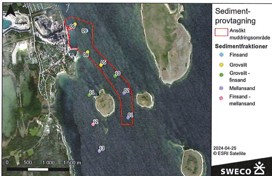
Figur 4-2 Punkter för sedimentprovtagning i närheten av muddringsområdet.
