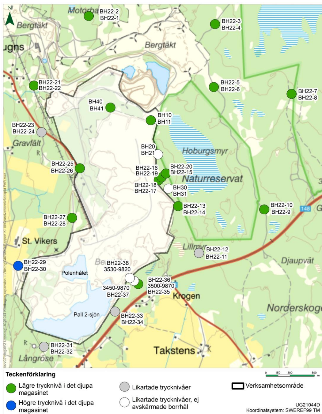
Figur 10. Läge och redovisning av skillnad i trycknivå för borrhålspar med grunda och djupa hål. Ett antal av de djupa borrhålen är inte avskärmade från det ytliga berget och kan då representera antingen ytligt eller djupt magasin eller en kombination av dessa beroende på vilka sprickor som ansluter till borrhålet.
