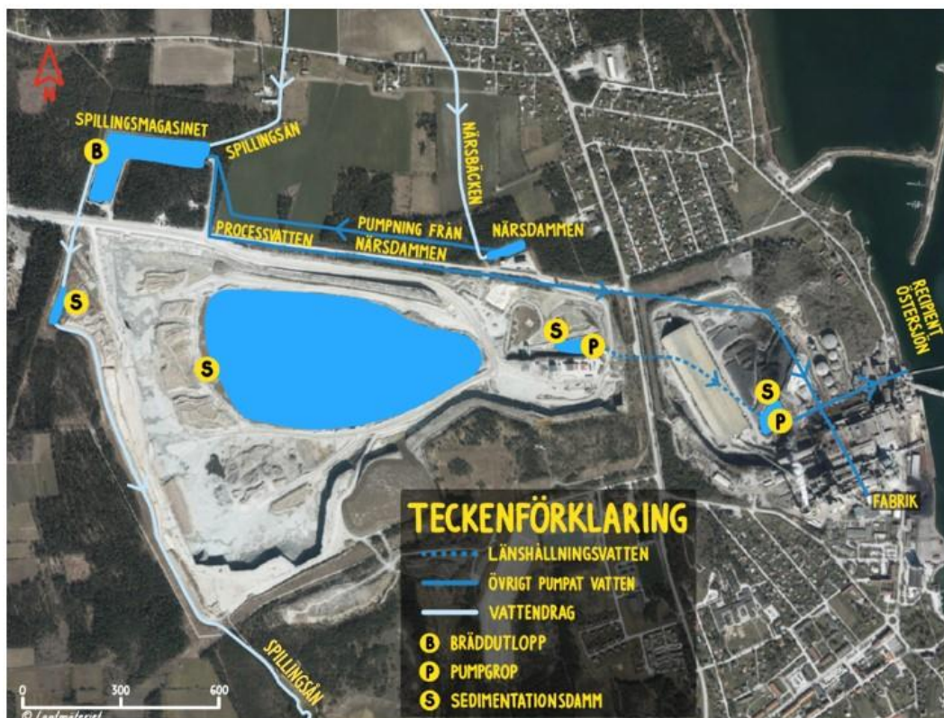
Figur 3. Schematisk bild över vattenhanteringen vid Västra brottet.
