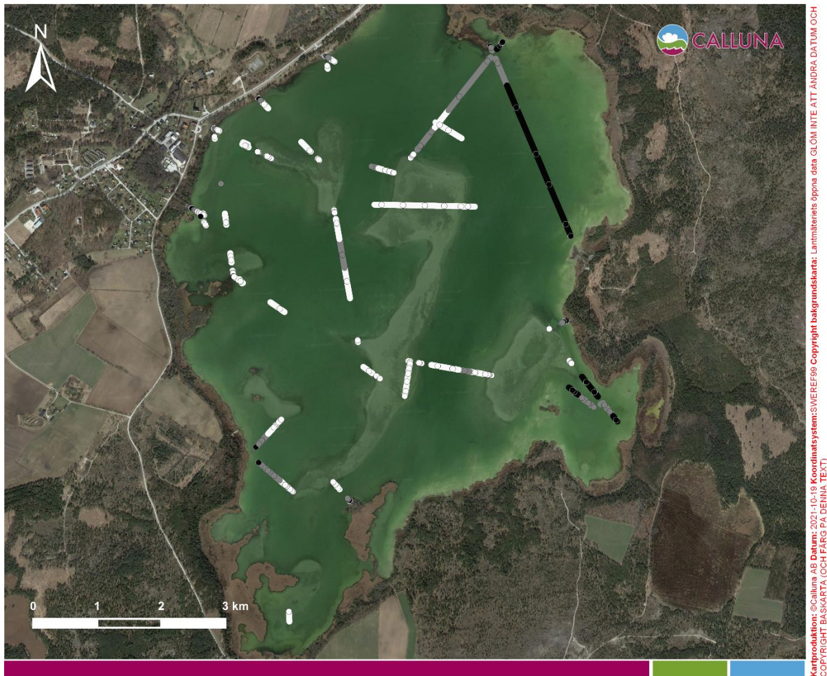
Figur 5. Sedimentets beskaffenhet i Tingstäde träsk. Svart färg är hård botten av kalksten, grå är fast sjöbotten som det inte skulle vara svårt att gå på, vit färg är mjuk eller mycket mjuk botten som det vore farligt att försöka gå på. Provpunkterna visas som små cirklar och mellan dem finns interpolerad färgklassning av sedimentets beskaffenhet. Observera att flygbilden i bakgrunden inte visar vegetationen särskilt bra, allt som är grönt på flygbilden är inte vegetation. Det ljusa sedimentet i sjön gör att djupt vatten ser mörkare grönt ut än grunt vatten.
