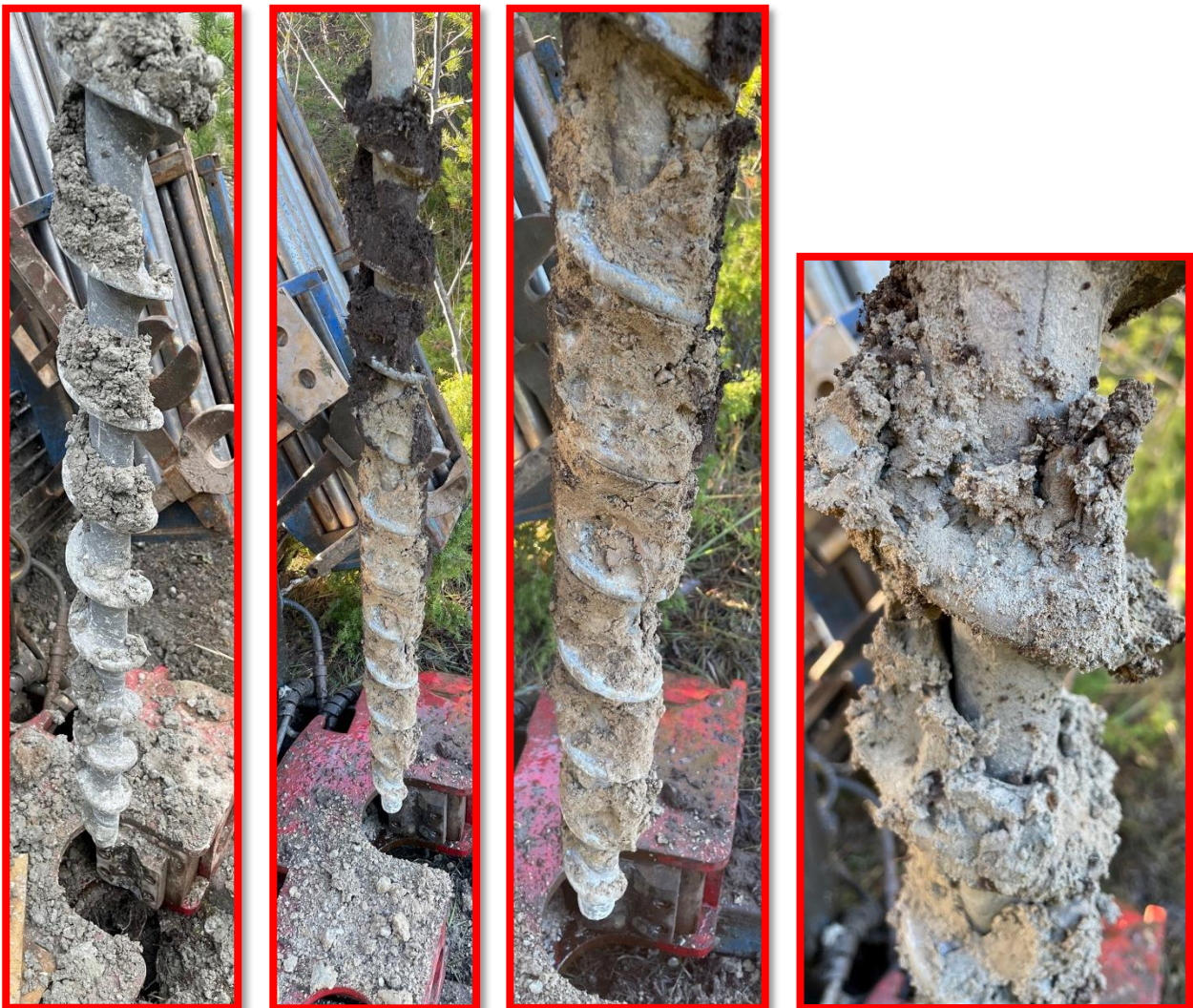
Figur 5. Bilder över utförda skruvsonderingar.
