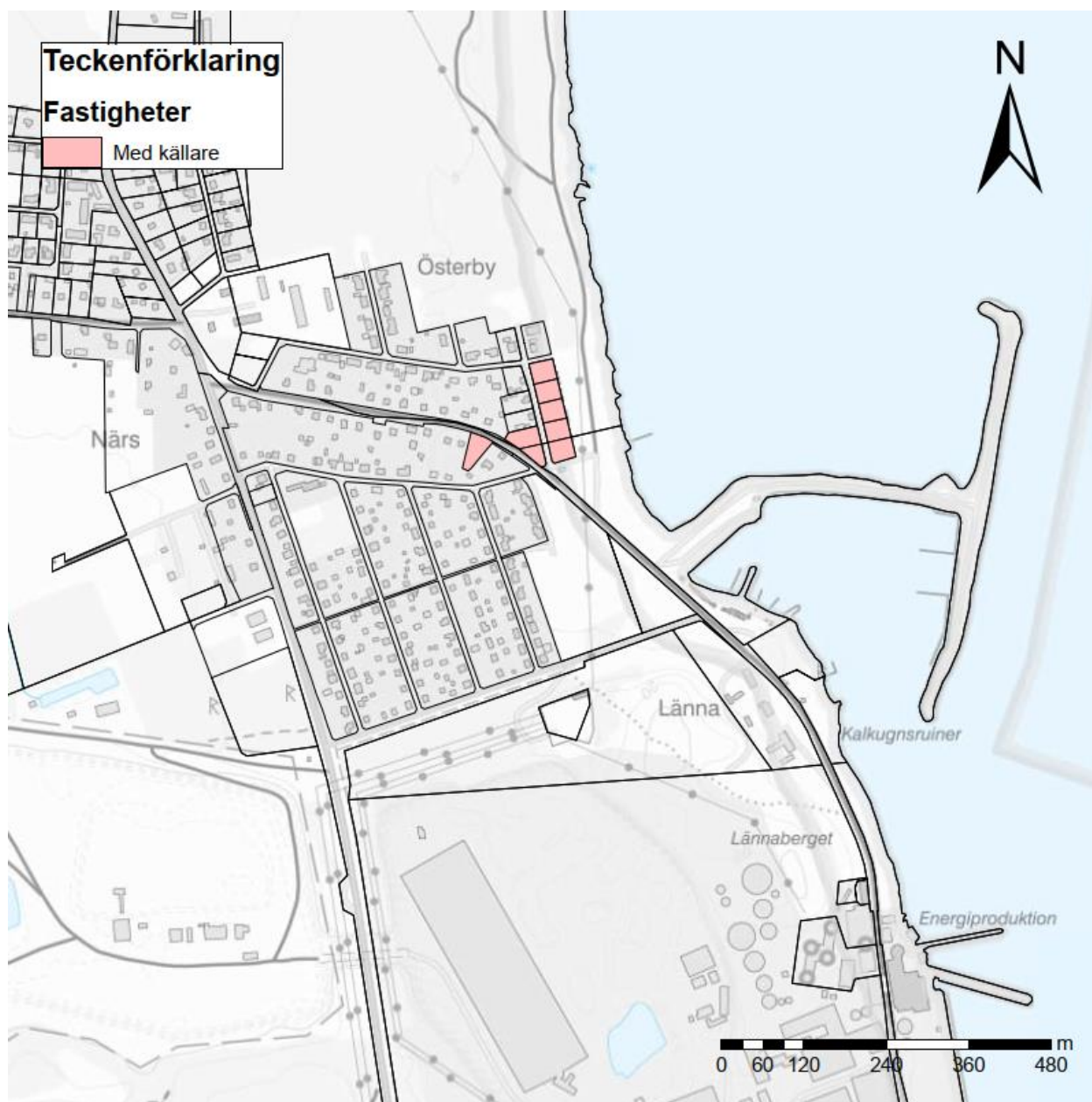
Figur 1 Fastigheter med källare som ligger på en marknivå under +4,9 i nordöstra Slite.
