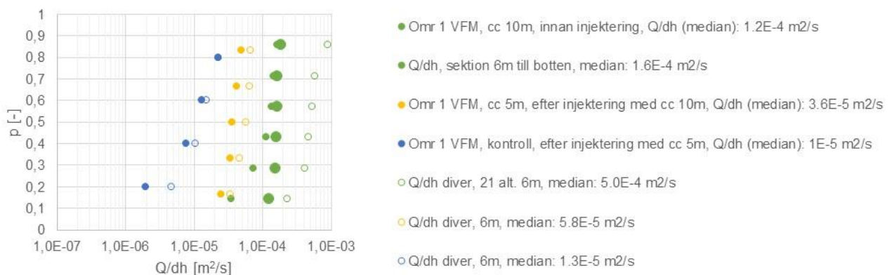
Figur 13. File hajdar-täkten, Område 1 (revkalksten, revets underkant): Q/dh för den mest genomsläppliga sektionen (43–60 m). Fyllda symboler, dh = h_w + h_p , ofyllda symboler, dh = h_{diver} \pm avstånd till grundvattnenytta innan test (baserat på nedmätning). Reduktion i varje steg. Gräns flöde: 400–570 liter/min vid 3.5 bar.
