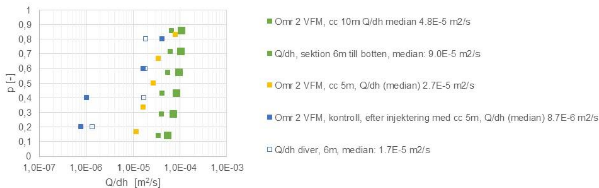
Figur 14. File hajdar-täkten, Område 2 (lagrad kalksten): Q/dh för den mest genomsläppliga sektionen (58–68 m). Sektion 29–47 m har strukturer i samma storleksordning som 58–68 m (skillnad mellan gröna kvadrater). Reduktion (median) i varje steg.
