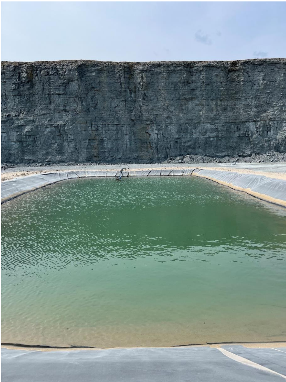
Figur 5: Den vattendamm som anlades som vattentillgång för infiltrationsförsöket i BH2212 under lågvattensäsong 2023. I bakgrunden syns slangen som går från täktbotten till infiltrationsbrunnen BH2212 uppe på File hajdar.
