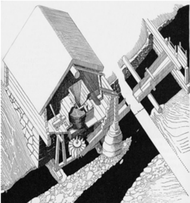
Figur 2. Principskis över en skvaltkvarn.
