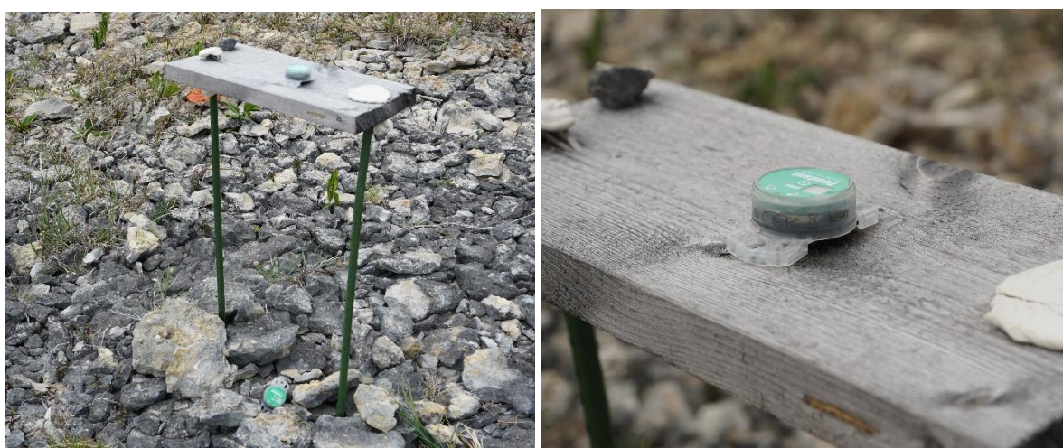
Fig. 21. Klimatstation med HOBO Pendant temperatur och ljus-datalogger placerad vid marknivå, ~50 centimeter över mark i skuggigt läge (under bräda) samt ~50 centimeter över mark i solläge (på bräda).
