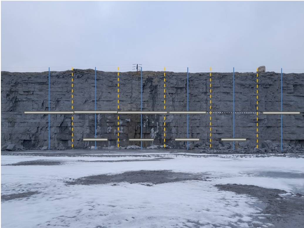
Figur 2. Blå, heldragna linjer representerar första omgångens borrhål. Borrhålen är vertikala och korsar då den vita streckade linjen som representerar en vattenförande struktur. Dessa borrhål vattenförlustmäts för att kunna bedöma hur genomsläppliga de är. Detta följs av injektering (grå färg representerar injekteringsmaterial). I nästa steg borrar mellanliggande borrhål (streckade orange linjer). Även dessa vattenförlustmäts och en jämförelse görs av genomsläppligheten, Q/dh , före och efter injektering (av omgång 1).
