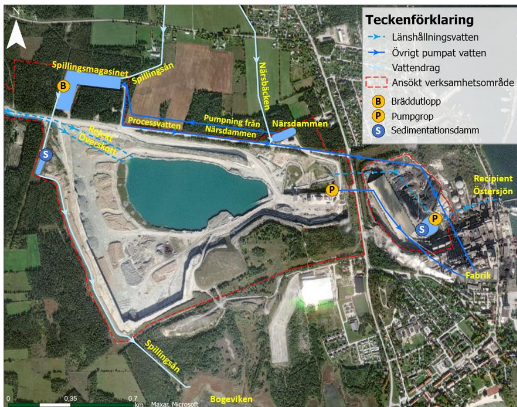
Figur 8.3 Vattenhanteringen i Västra och Östra brottet i den ansökta verksamheten. (Källa: Ansökans bilaga B6)
