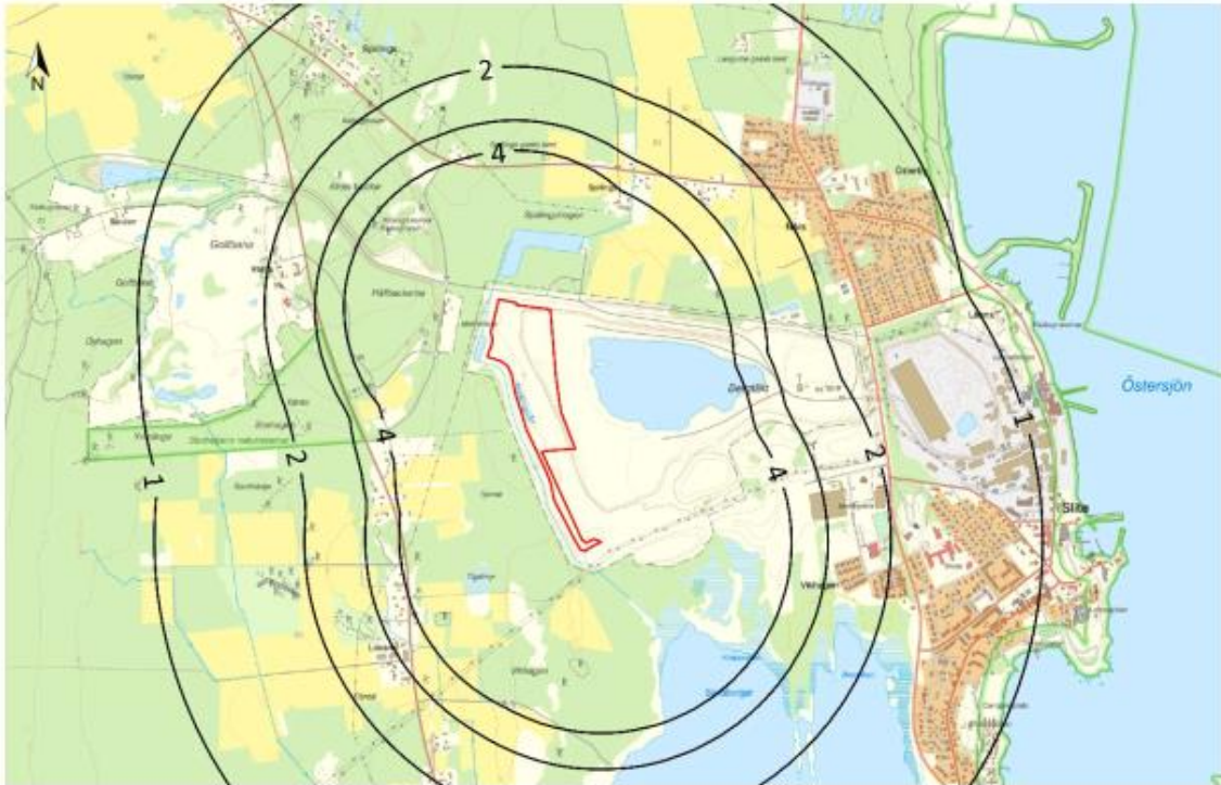
Figur 11.47 Prognostiserad maximal vibrationsnivå (mm/s) vid Västra brottet utifrån en laddningsmängd på 130–270 kg. Rött område markerar det område där det finns kvarvarande sten som ska brytas ut.
