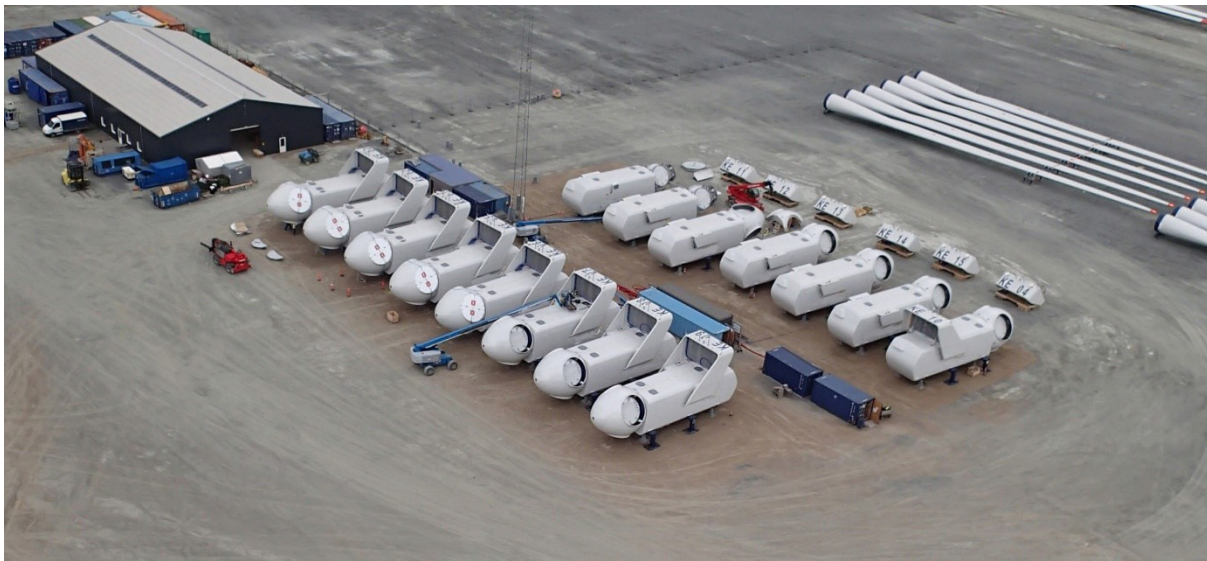
Figur 30. Nacell som vid slutmonteringshamnen färdigställs för installation. Källa Göran Loman
