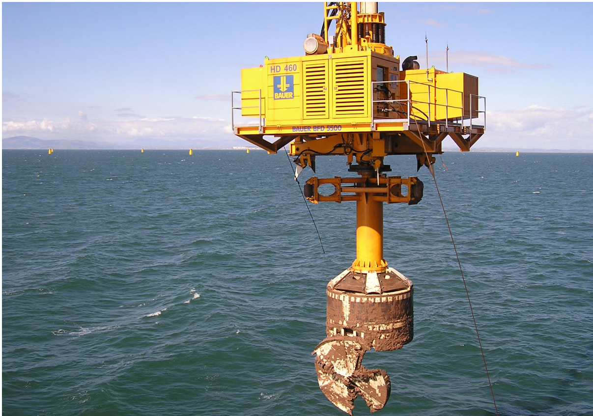
Figur 10 Exempel på borr som kan användas vid borrning av pålar. Källa: Bauer Group
